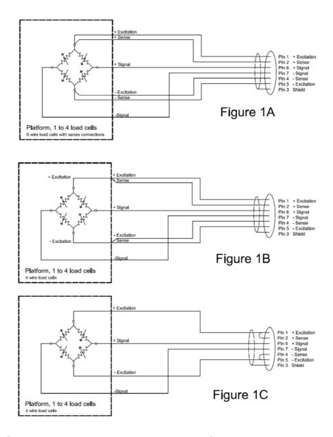
Le modèle GK-Mplus doit utiliser la connexion à 6 fils et présente certaines limitations quant à la taille et à la longueur des fils. Consultez le certificat d'essai d'homologation pour plus de détails.
